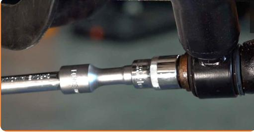
**16** Serrez la fixation supérieure de l'amortisseur. Utilisez une douille n° 18. Utilisez une clé mixte de No.22.
