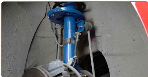
**67** Serrez la fixation reliant la biellette à l'amortisseur. Utilisez une douille n° 17. Utilisez une clé dynamométrique. Serrez-le jusqu'à 40 Nm.
