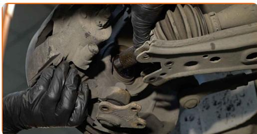
**54** Montez l'arbre de transmission sur le moyeu de roue.
