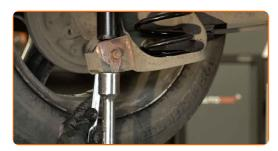
Dévissez l'attache inférieure de l'amortisseur. Utilisez une clé mixte de No.16 Utilisez une douille n° 16. Utilisez une clé à cliquet.
