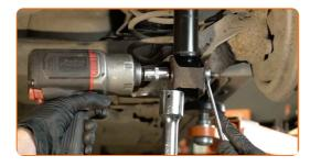
Retirez l'écrou de fixation.
