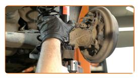
23 Installez l'écrou de fixation.
