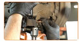
Serrez l'attache inférieure de l'amortisseur. Utilisez une clé mixte de No.16 Utilisez une douille n° 16. Utilisez une clé dynamométrique. Serrez-le jusqu'à 40 Nm.+90°
