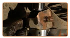
Serrez l'attache inférieure de l'amortisseur. Utilisez une clé mixte de No.16 Utilisez une douille n° 16. Utilisez une clé dynamométrique. Serrez-le jusqu'à 40 Nm.+90°
