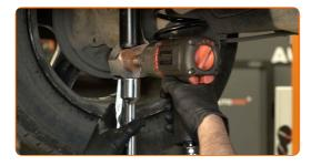
Retirez l'écrou de fixation.
