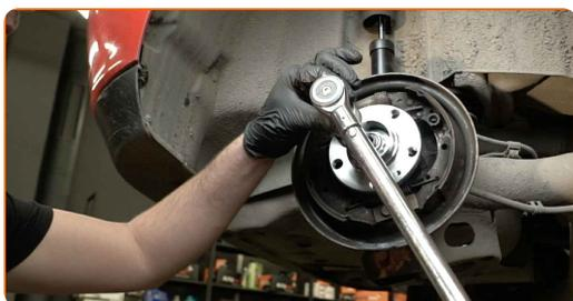
Remplacement : roulement de roue – Seat Ibiza 6L1. Les professionnels recommandent :
