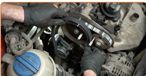
**Remplacement : pompe à eau + kit de courroie de distribution – Seat Ibiza 6L1. AUTODOC recommande :**
