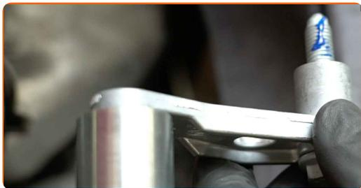
**71** Installez le support du galet enrouleur de la courroie de distribution avec poulie intégrée.
