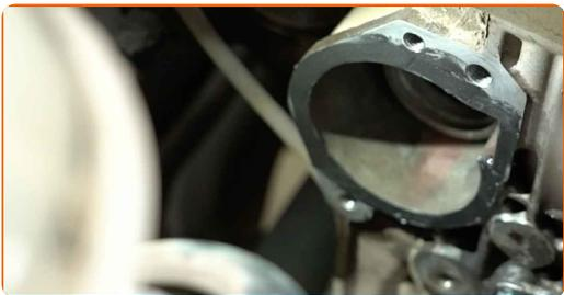
**57** Appliquez du produit sur l'emplacement de montage de la pompe à eau. Utilisez un enduit.
