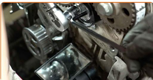
**75** Installez la nouvelle courroie de distribution conformément aux repères de calage.
