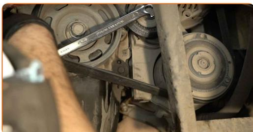
**96** Mettez de côté la poulie de tendeur de la courroie en V crantée. Utilisez une clé mixte de No.16.
