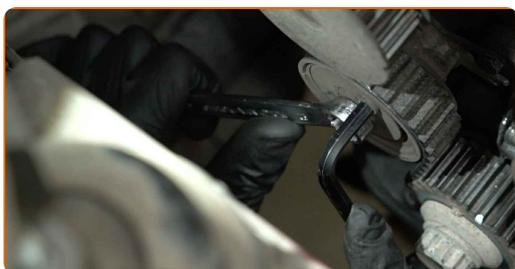
**42** Retirez le galet tendeur de la courroie de distribution.
