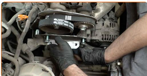
**83** Serrez les écrous de fixation du support moteur. Utilisez une douille n° 16. Utilisez une clé dynamométrique. Serrez-le jusqu'à 50 Nm.
