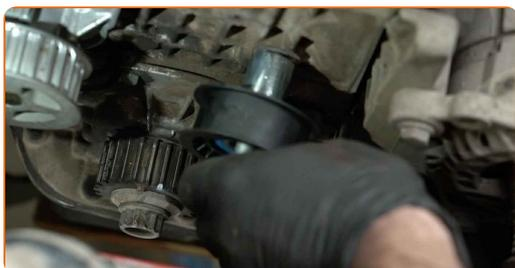
**69** Serrez la fixation du galet enrouleur de la courroie de distribution. Utilisez une douille n° 15. Utilisez une clé dynamométrique. Serrez-le jusqu'à 25 Nm.
