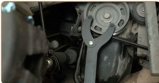
**101** Remplacez la poulie du tendeur à sa position initiale. Utilisez une clé mixte de No.16.
