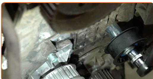
**70** Appliquez du produit sur les boulons de serrage. Utilisez un enduit.
