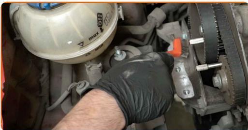
**35** Dévissez les fixations du support moteur. Utilisez une douille n° 16. Utilisez une clé à cliquet.
