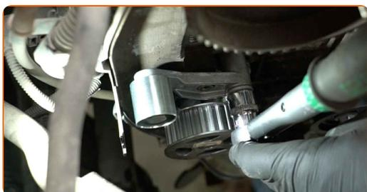
**73** Ajustez la tension de la courroie de distribution en déplaçant le galet tendeur. Utilisez une clé mixte de No.16 Utilisez la clé HEX n° H6.
