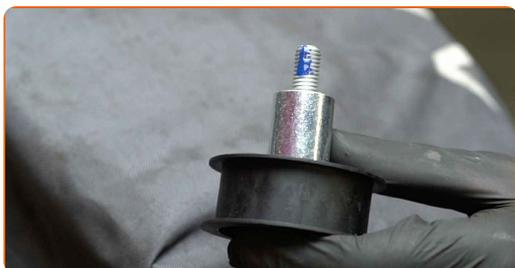
**68** Installez le galet enrouleur de la courroie de distribution.
