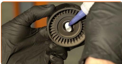
**94** Installez le galet tendeur de la courroie poly-V.
