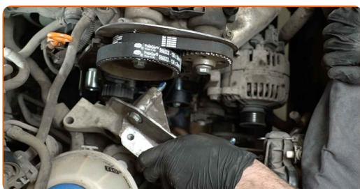
**82** Installez les boulons de fixation.
