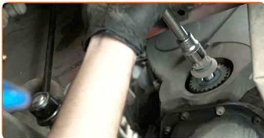
**24** Dévissez les fixations du carter de distribution inférieur. Utilisez une douille n° 10. Utilisez une clé à cliquet.
