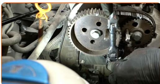
**67** Appliquez du produit sur les boulons de serrage. Utilisez un enduit.
