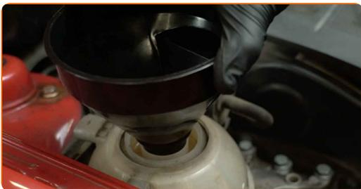
**111** Versez du liquide de refroidissement dans le réservoir.
