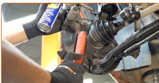
**14** Dévissez l'attache du support d'étrier. Utilisez une douille n° 18. Utilisez une clé à cliquet.
