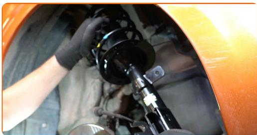
**34** Vissez l'attache supérieure du support de l'amortisseur. Ne serrez pas trop.
