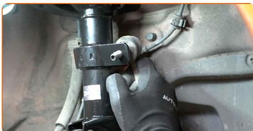
**43** Serrez la fixation reliant la biellette à l'amortisseur. Utilisez une douille n° 16. Utilisez une clé dynamométrique. Serrez-le jusqu'à 23 Nm.
