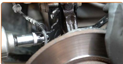
**48** Serrez les fixations inférieures qui relient l'amortisseur à la fusée d'essieu. Utilisez une clé mixte de No.15 Utilisez une douille n° 17. Utilisez une clé dynamométrique. Serrez-le jusqu'à 75 Nm.
