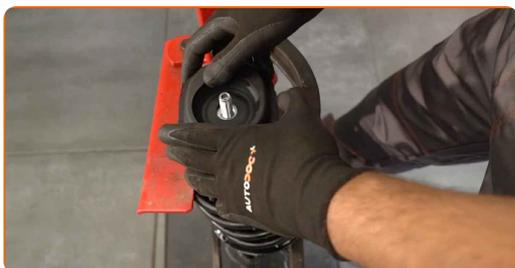
**37** Serrez l'écrou de l'entretoise d'amortisseur due la tige de piston. Utilisez une clé mixte de No.27 Utilisez la clé HEX n° H6. Utilisez une clé dynamométrique. Serrez-le jusqu'à 45 Nm.
