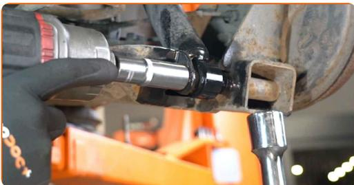
**11** Retirez l'écrou de fixation.
