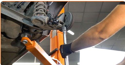
**8** Dévissez l'attache supérieure de l'amortisseur. Utilisez une douille n° 15. Utilisez une clé à cliquet.
