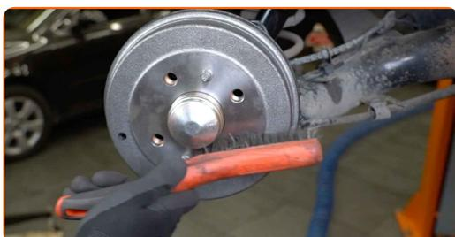
**25** Appliquez du produit sur la surface de contact entre la jante et le tambour de frein. Utilisez de la graisse au cuivre.
