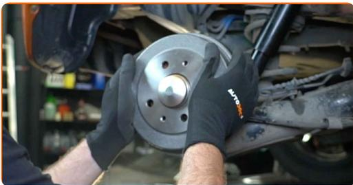
**19** Serrez les fixations des tambours de frein. Utilisez une douille n° 12. Utilisez une clé dynamométrique. Serrez-le jusqu'à 10 Nm.
