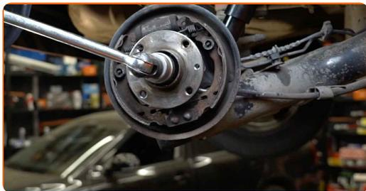
**11** Retirez le moyeu et le roulement puisqu'ils forment un bloc hermétique.
