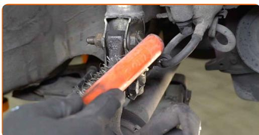
**16** Dévissez l'écrou d'attache d'extrémité à la fusée d'essieu. Utilisez une douille n° 19. Utilisez une clé à cliquet.
