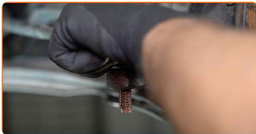
**54** Vissez l'écrou de fixation reliant l'embout de biellette à la fusée d'essieu. Utilisez une douille n° 19. Utilisez une clé à cliquet.
