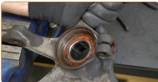
**36** Faites sortir le palier du moyeu de roue. Servez-vous d'un coffret de douilles et de roulements.
