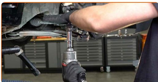
**55** Serrez la fixation connectant le joint à rotule à la fusée d'essieu. Utilisez une douille n° 17. Utilisez une clé dynamométrique. Serrez-le jusqu'à 55 Nm.
