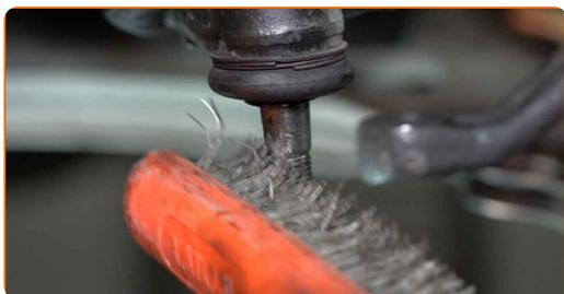
**53** Connectez l'extrémité du tirant à la fusée d'essieu.
