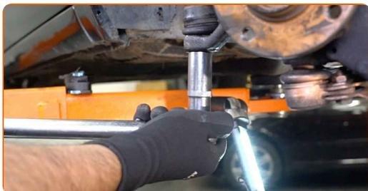
**56** Serrez les fixations inférieures qui relient l'amortisseur à la fusée d'essieu. Utilisez une clé mixte de No.19 Utilisez une douille n° 19. Utilisez une clé dynamométrique. Serrez-le jusqu'à 80 Nm.
