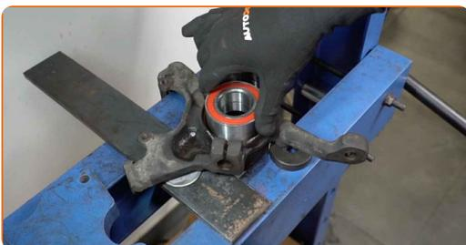
Remplacement : roulement de roue – VW Golf 2. AUTODOC recommande :
