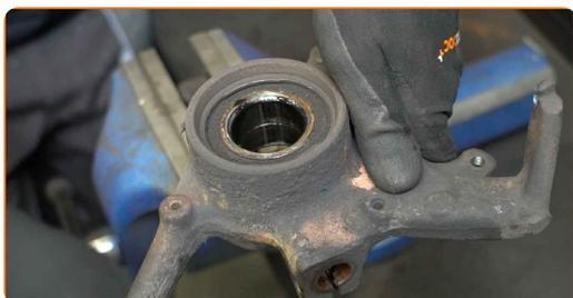
**31** Nettoyez la bague de retenue du roulement de moyeu de la roue. Utilisez une brosse métallique. Servez vous de l'aérosol WD-40.
