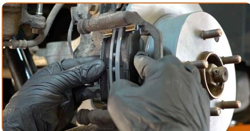
Remplacement : plaquettes de frein – INFINITI EX 3/5 portes (J50). Les professionnels recommandent :
