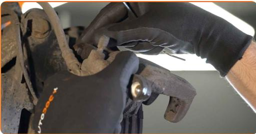
Remplacement : plaquettes de frein – INFINITI EX 3/5 portes (J50). AUTODOC recommande :
