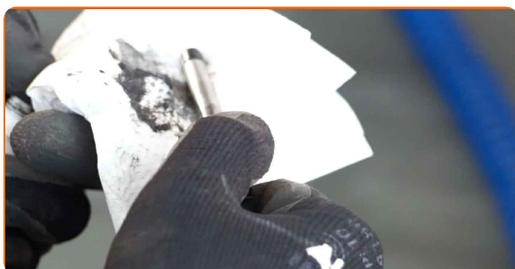
**18** Lubrifiez les goupilles de guidage avec de la graisse spéciale.
