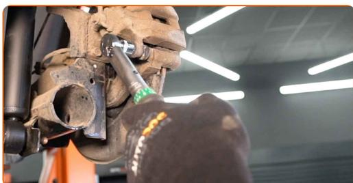
**20** Appliquez du produit sur la zone de contact entre le disque de frein et la jante. Utilisez de la graisse au cuivre.
