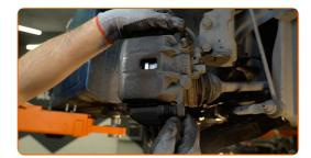
Appliquez du produit sur la zone de contact entre le disque de frein et la jante. Utilisez de la graisse au cuivre.
