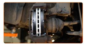
Installez l'étrier de frein et fixez-le. Utilisez une douille n° 12. Utilisez une clé dynamométrique. Serrez-le jusqu'à 23 Nm.
