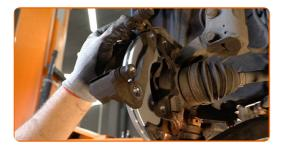
Serrez le support de l'étrier de frein. Utilisez une douille n° 19. Utilisez une clé dynamométrique. Serrez-le jusqu'à 108 Nm.
