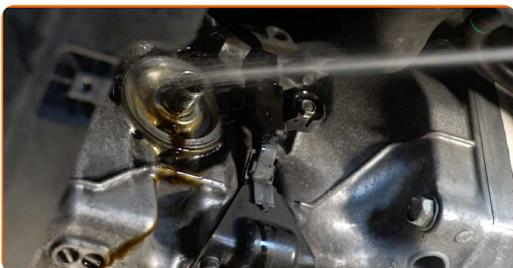
**15** Lubrifiez le joint en caoutchouc du nouveau filtre avec une petite quantité d'huile neuve.
