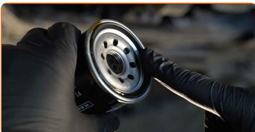
**16** Vissez le filtre neuf en place. Utilisez la douille 65-14F. Utilisez une clé dynamométrique. Serrez-le jusqu'à 18 Nm.
