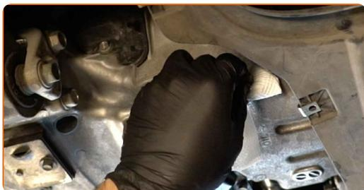
**18** Vissez le nouveau bouchon de vidange et le resserrez. Utilisez une douille n° 17. Utilisez une clé dynamométrique. Serrez-le jusqu'à 27 Nm.
