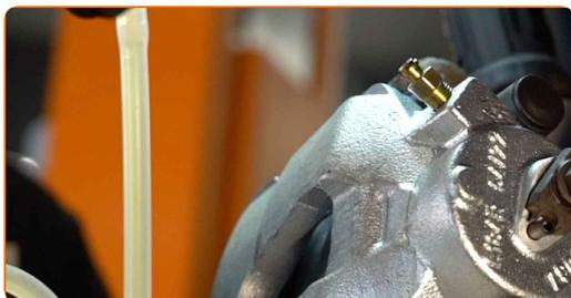
**30** Resserrez la vis de purge de l'étrier de frein. Utilisez une douille n° 11. Utilisez une clé dynamométrique. Serrez-le jusqu'à 10 Nm.
