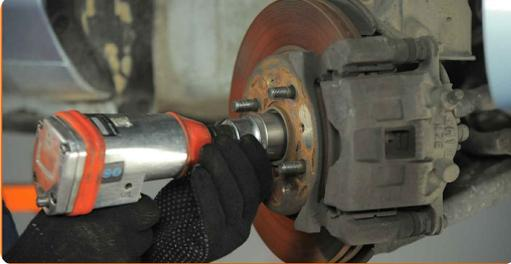
9 Retirez l'écrou de fixation.
