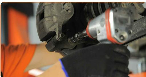
**54** Installez l'écrou de fixation.
