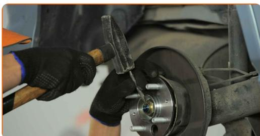
**26** Installez le bouchon de protection du moyeu de roue. Servez-vous d'un maillet en caoutchouc.
