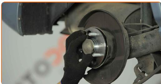
**27** Lubrifiez le moyeu à l'endroit où il est en contact avec le disque de frein. Utilisez de la graisse au cuivre.
