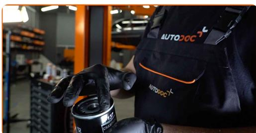
**14** Vissez le filtre neuf en place. Utilisez la douille 76/14-F. Utilisez une clé dynamométrique. Serrez jusqu'à 19 Nm.
