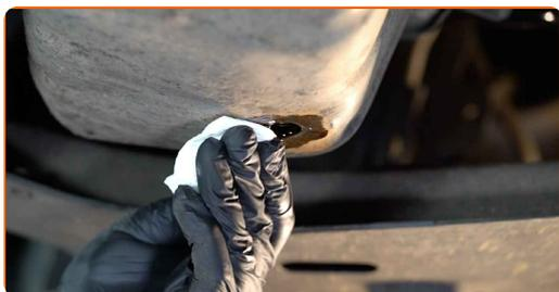
**16** Vissez le nouveau bouchon de vidange et le resserrez. Servez-vous d'une douille de vidange carrée n°8. Utilisez une clé dynamométrique. Serrez-le jusqu'à 20 Nm.
