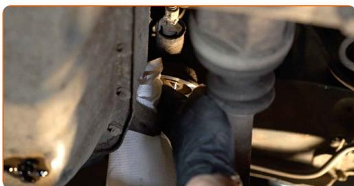
**13** Lubrifiez le joint en caoutchouc du nouveau filtre avec une petite quantité d'huile neuve.
