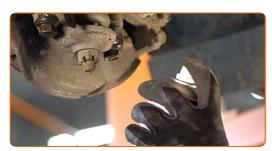
Dévissez l'attache inférieure du support de l'amortisseur. Utilisez une douille n° 19.
