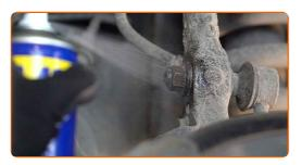
Dévissez les fixations reliant la biellette stabilisatrice à la fusée d'essieu. Utilisez une douille n° 17. Utilisez une clé mixte de No.17 Utilisez la clé HEX n° H6.
