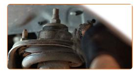
Dévissez l'attache supérieure de l'entretoise de l'amortisseur. Utilisez une clé mixte de No.14 Retirez l'écrou de fixation.
