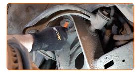
Appliquez du produit sur les emplacements de montage de la jambe d'amortisseur. Utilisez de la graisse au cuivre.
