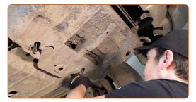
Retirez le carénage sous moteur.
