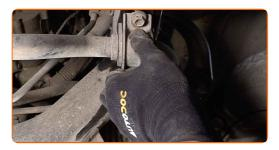
Vissez les fixations des brides de silentblocs de barre stabilisatrice. Utilisez une douille n° 14. Utilisez une clé dynamométrique. Serrez-le jusqu'à 25 Nm.
