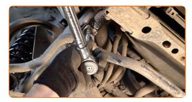
Serrez les fixations reliant la biellette stabilisatrice à la fusée d'essieu. Utilisez une clé mixte de No.22 Utilisez une douille n° 17. Utilisez la clé HEX n° H6. Utilisez une clé dynamométrique. Serrez-le jusqu'à 65 Nm.
