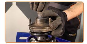
Serrez l'écrou de l'entretoise d'amortisseur due la tige de piston. Utilisez une clé mixte de No.17 Servez-vous d'une clé ajustable. Utilisez une clé dynamométrique. Serrez-le jusqu'à 25 Nm.
