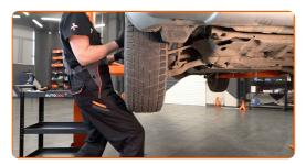
6 Défaites les attaches du carénage sous moteur. Utilisez une douille n° 12.
