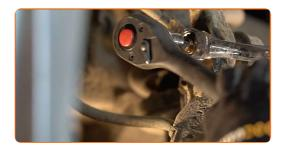
Dévissez les fixations des brides de silentblocs de barre stabilisatrice. Utilisez une douille n° 14.
