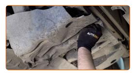
Serrez les fixations du carénage sous moteur. Utilisez une douille n° 12.
