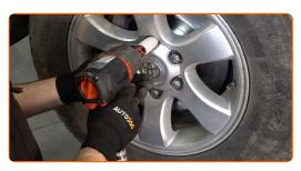
Abaissez la voiture et serrez les boulons de roue en ordre croisé. Utilisez une clé dynamométrique. Serrez-le jusqu'à 112 Nm.
