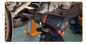
Dévissez l'attache entre le joint rotule et la fusée d'essieu. Utilisez une douille n° 19. Utilisez un porte-taraud.
