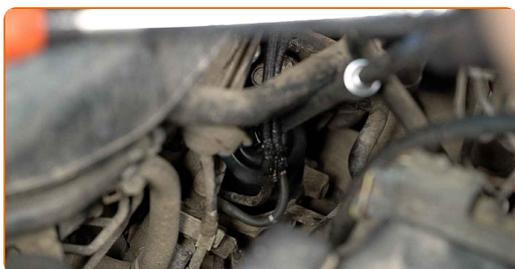
**20** Retirez le bouchon du bec de remplissage d'huile. Insérez l'entonnoir.
