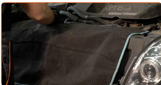
**3** Nettoyez le bouchon de l'orifice de remplissage d'huile. Servez-vous d'un aérosol nettoyant multi-usages.
