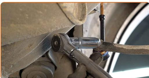
**15** Attachez la biellette stabilisatrice à la poutre de torsion arrière.
