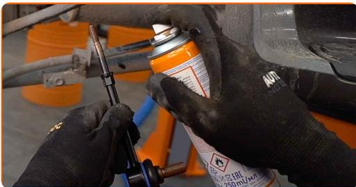
**13** Installez une nouvelle barre, serrez les attaches.
