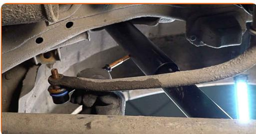
**14** Serrez la fixation reliant la biellette à la barre stabilisatrice. Utilisez une clé mixte de No.17 Utilisez la clé HEX n° H6. Utilisez une clé dynamométrique. Serrez-le jusqu'à 65 Nm.
