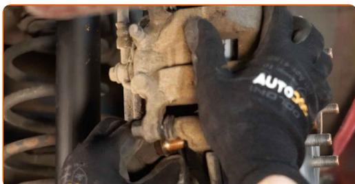
**26** Serrez le support de l'étrier de frein. Utilisez une douille n° 19. Utilisez une clé dynamométrique. Serrez-le jusqu'à 84 Nm.
