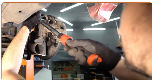
**27** Appliquez du produit sur la zone de contact entre le disque de frein et la jante. Utilisez de la graisse au cuivre.
