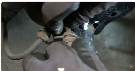
**13** Détachez le connecteur du capteur ABS. Utilisez un tournevis plat.
