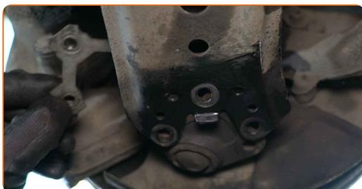
**58** Installez les boulons de fixation.
