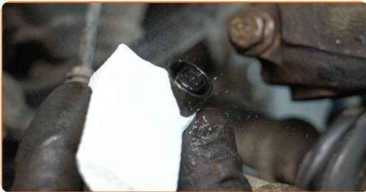
**64** Attachez le connecteur du capteur ABS.
