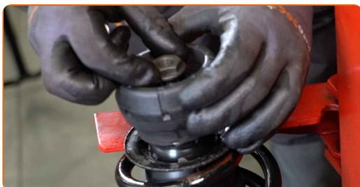
**43** Serrez l'écrou de la tige de piston de la jambe de suspension. Utilisez une douille pour écrou de jambe de suspension de 21 mm. Servez-vous d'un embout d'amortisseur n°DD9. Utilisez une clé dynamométrique. Serrez-le jusqu'à 60 Nm.
