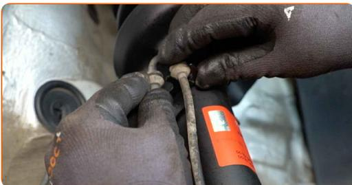
**66** Serrez les fixations inférieures de la jambe de suspension. Utilisez une douille n° 18. Utilisez une clé dynamométrique. Serrez-le jusqu'à 50 Nm.+90°
