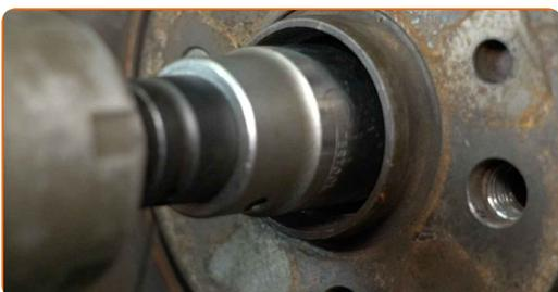
**62** Vissez la fixation inférieure de la jambe d'amortisseur. Utilisez une douille n° 18. Utilisez une clé à cliquet.
