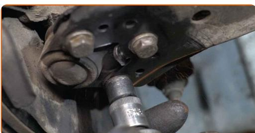
**60** Installez l'écrou de fixation.
