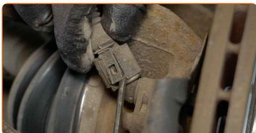
**14** Nettoyez la fixation inférieure reliant la jambe de suspension à la fusée d'essieu. Utilisez une brosse métallique. Servez vous de l'aérosol WD-40.
