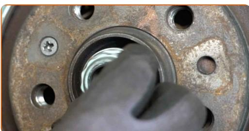
**61** Vissez la fixation du demi-arbre de transmission. Utilisez une douille n° 30. Utilisez une clé à cliquet.
