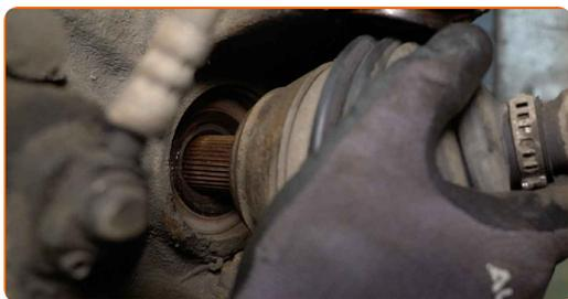
**57** Attachez le joint à rotule au bras de contrôle.
