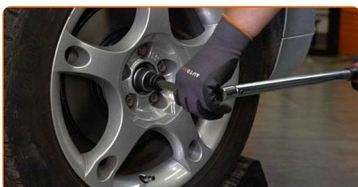
**77** Serrez en étoile les boulons de la roue. Servez-vous d'une douille à choc pour roue N°17. Utilisez une clé dynamométrique. Serrez-le jusqu'à 120 Nm.
