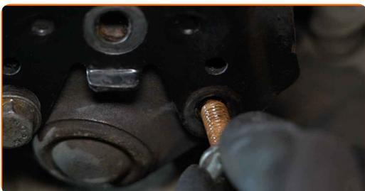
**59** Serrez les fixations qui relient le joint à rotule au bras de suspension. Utilisez une douille n° 13. Utilisez une clé à cliquet.
