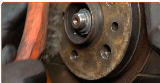
**71** Appliquez du produit sur la zone de contact entre le disque de frein et la jante. Utilisez du lubrifiant céramique.
