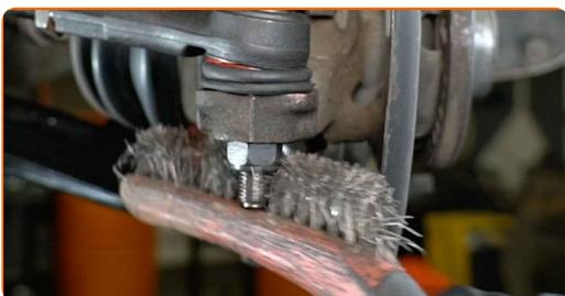
**20** Dévissez l'écrou de fixation reliant l'extrémité de la biellette de direction à la fusée d'essieu. Utilisez une douille n° 19. Utilisez une clé à cliquet.
