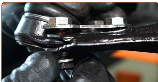
**60** Serrez les fixations qui relient le joint à rotule au bras de suspension. Utilisez une douille n° 13. Utilisez une clé à cliquet.
