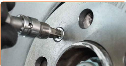
**75** Serrez les fixations du disque de frein. Serrez-vous d'un tournevis Phillips. Utilisez une clé dynamométrique. Serrez-le jusqu'à 4 Nm.
