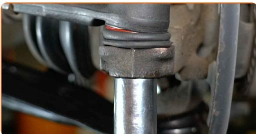
**21** Déconnectez l'extrémité de la biellette de direction de la fusée d'essieu. Servez-vous d'un extracteur de rotules.
