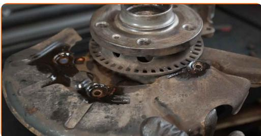
**39** Retirez le moyeu de roue de la fusée d'essieu. Utilisez un coffret de douilles et de roulements.
