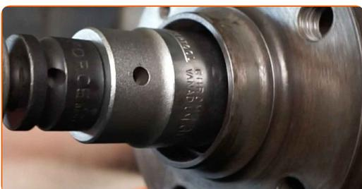
**67** Appliquez du produit sur le connecteur du capteur ABS. Utilisez de la graisse diélectrique.
