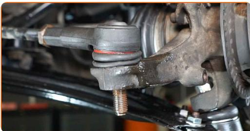
**70** Vissez l'écrou de fixation reliant l'embout de biellette à la fusée d'essieu. Utilisez une douille n° 19. Utilisez une clé à cliquet.
