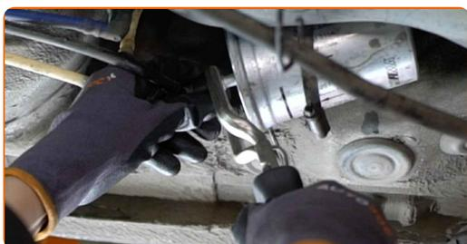
Remplacement : filtre à carburant – Seat Leon 1M1. AUTODOC recommande :
