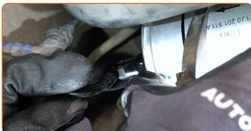
**14** Vissez le support de montage du filtre à carburant. Utilisez une douille n° 7. Utilisez une clé à cliquet.
