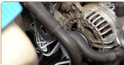
**11** Faites tourner le vilebrequin plusieurs fois pour vérifier le bon fonctionnement de la nouvelle courroie trapézoïdale striée. Utilisez une douille n° 19. Utilisez une clé à cliquet.
