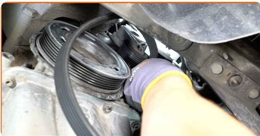
Remplacement : courroie poly V – Seat Leon 1M1. AUTODOC recommande :
