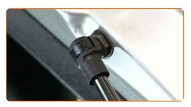
Détendez l'anneau de retenue reliant le vérin à gaz au couvercle de coffre. Utilisez un tournevis plat.
