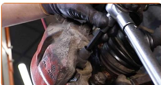
**37** Installez les bouchons anti-poussière des goupilles de guidage de l'étrier de frein.
