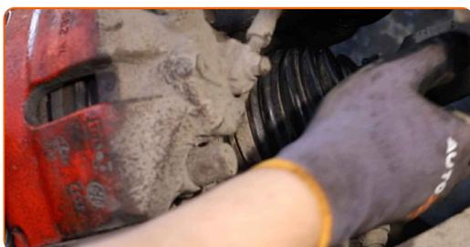
**66** Installez le boulon de l'arbre de transmission et serrez-le. Servez-vous d'une douille 12 pans n°24. Utilisez une clé à cliquet.
