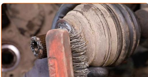
**56** Appliquez du produit sur les cannelures de joint de l'arbre de transmission. Utilisez de la graisse au cuivre.
