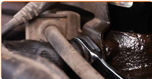
**77** Serrez le collier de serrage du flexible de frein de l'entretoise de l'amortisseur. Utilisez une douille n° 10. Utilisez une clé dynamométrique. Serrez-le jusqu'à 12 Nm.
