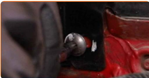
**92** Serrez les fixations du panneau en plastique. Utilisez la mèche Torx T30. Utilisez une clé dynamométrique. Serrez-le jusqu'à 8 Nm.
