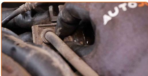
**76** Serrez l'attache qui relie le support du flexible de frein à la jambe de suspension. Utilisez une clé mixte de No.10
