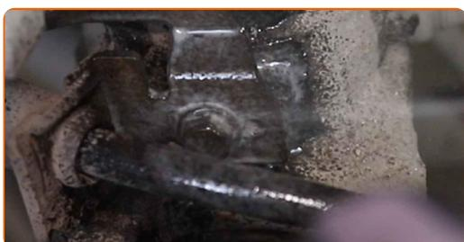
**20** Dévissez l'attache qui relie le support du flexible de frein à la jambe de suspension. Utilisez une clé mixte de No.10
