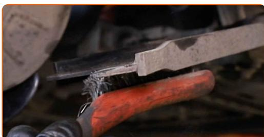
**58** Nettoyez le siège de montage de la jambe de suspension sur la fusée d'essieu. Nettoyez le siège de montage de l'essieu homocinétique. Utilisez une brosse métallique. Servez vous de l'aérosol WD-40.
