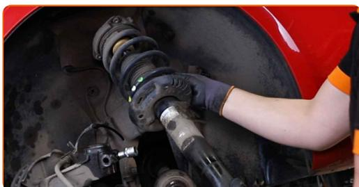
**36** Installez la jambe de suspension sur le compresseur de ressort.
