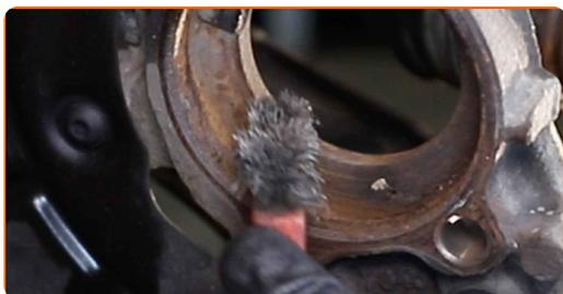
**28** Appliquez un produit sur l'emplacement de montage du moyeu de roue. Utilisez de la graisse au cuivre.
