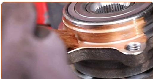
**29** Installez le nouveau moyeu de roue avec le roulement.
