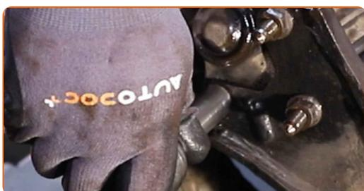
**40** Appliquez du produit sur les fixations de la rotule. Utilisez de la graisse au cuivre.
