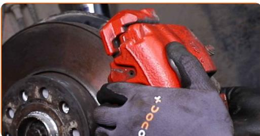
**45** Installez les boulons de fixation.
