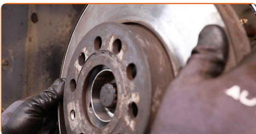
**43** Serrez l'attache du disque de frein. Utilisez la mèche Torx T30. Utilisez une clé dynamométrique. Serrez-le jusqu'à 4 Nm.
