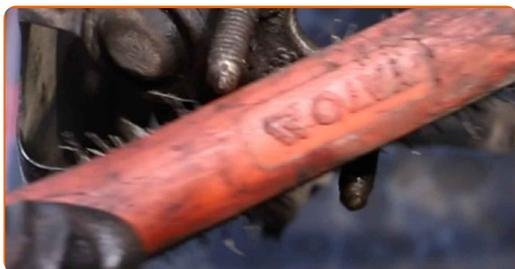
**38** Attachez le joint à rotule au bras de contrôle.
