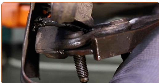
**39** Serrez les fixations reliant le joint à rotule au bras de commande. Utilisez une douille n° 16. Utilisez une clé dynamométrique. Serrez-le jusqu'à 60 Nm.
