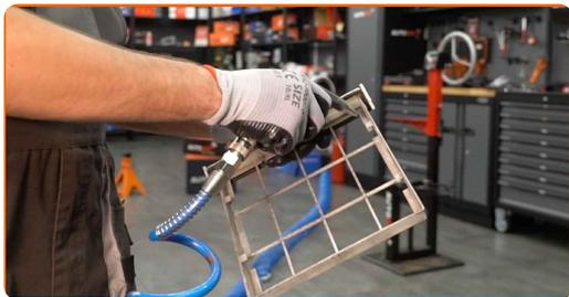
**7** Insérez un nouvel élément filtrant dans le compartiment du filtre. Assurez-vous que le cadre du filtre s'insère de manière ferme dans le boîtier.
