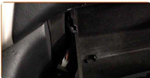
**3** Déverrouillez les clips du couvercle du filtre d'habitacle. Retirez le couvercle du compartiment du filtre habitacle.
