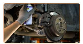
Installez une nouvelle barre, serrez les attaches. Utilisez une douille n° 17. Utilisez une clé à cliquet.
