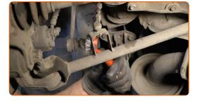
Dévissez les fixations qui relient la biellette à la barre stabilisatrice. Utilisez une douille n° 17. Utilisez une clé à cliquet.
