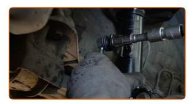
Serrez la fixation reliant la biellette à la barre stabilisatrice. Utilisez une douille n° 17. Utilisez une clé dynamométrique. Serrez-le jusqu'à 39 Nm.
