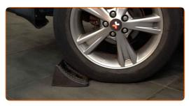
Desserrez les boulons de fixation de la roue. Servez-vous d'une douille à choc pour roue N°21.
