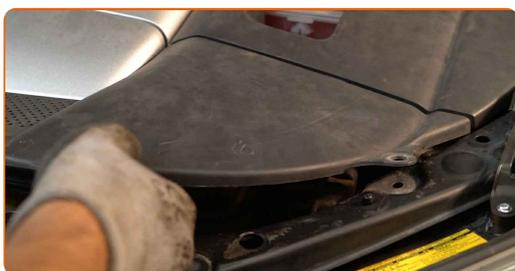
**12** Retirez les clips du couvercle de protection du moteur.
