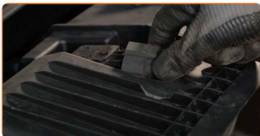
**17** Dévissez le collier de serrage du résonateur de prise d'air du boîtier de filtre à air. Utilisez une douille n° 10. Utilisez une clé à cliquet.
