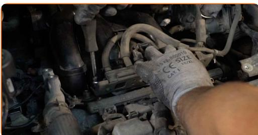
**80** Attachez le tuyau du capteur de vide.
