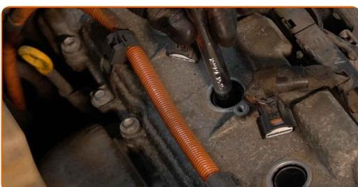
**58** Vissez les nouvelles bougies et serrez-les. Servez-vous de la douille de bougie d'allumage n°16. Utilisez une clé dynamométrique. Serrez-le jusqu'à 26 Nm.
