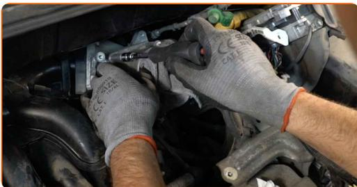
**74** Attachez le tuyau de ventilation du carter à gauche du cache moteur.
