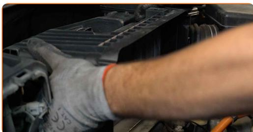
**90** CVissez les boulons de fixation du compartiment filtre. Utilisez une douille n° 10. Utilisez une clé à cliquet.
