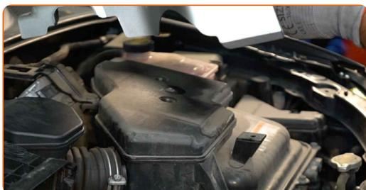
**14** Dévissez les fixations du boîtier du filtre à air. Utilisez une douille n° 10. Utilisez une clé à cliquet.
