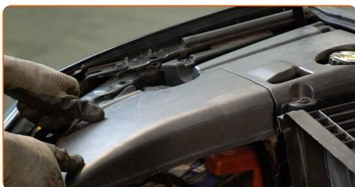
**94** Installez le couvercle du moteur. Réinstallez les clips du couvercle de protection du moteur.
