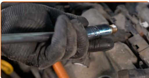
**56** Appliquez une fine couche d'antigrippant à haute température sur les fils des nouvelles bougies d'allumage.
