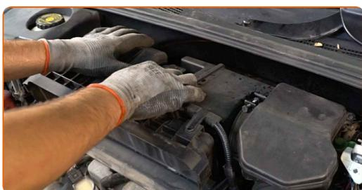
**93** Installez le couvercle de la batterie. Réinstallez les clips du couvercle de protection de la batterie.
