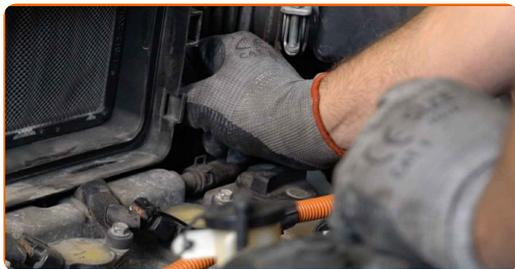
**91** Vissez le collier de serrage du résonateur de prise d'air au boîtier de filtre à air. Utilisez une douille n° 10. Utilisez une clé à cliquet.
