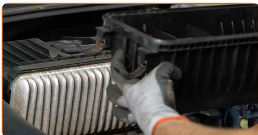
**10** Retirez l'élément filtrant du compartiment du filtre.
