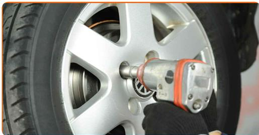
**16** Abaissez la voiture et serrez les boulons de roue en ordre croisé. Servez-vous d'une douille à choc pour roue N°17. Utilisez une clé dynamométrique. Serrez-le jusqu'à 110 Nm.
