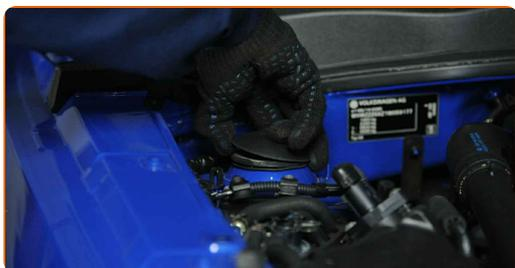
**15** Dévissez l'attache supérieure du support de l'amortisseur. Utilisez une douille n° 21. Utilisez la clé HEX n° H6. Utilisez une clé à cliquet.
