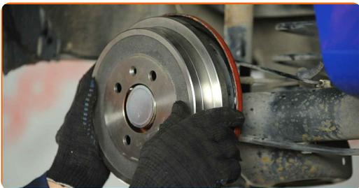
**20** Serrez les fixations des tambours de frein. Servez-vous d'un tournevis Phillips. Utilisez une clé dynamométrique. Serrez-le jusqu'à 4 Nm.
