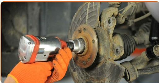
**14** Dévissez l'écrou d'attache d'extrémité à la fusée d'essieu. Utilisez une douille n° 22. Utilisez une clé à cliquet.
