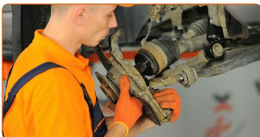
**32** Connectez le joint rotule à la fusée d'essieu.
