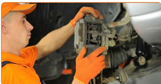
**44** Serrez le support de l'étrier de frein. Utilisez une douille n° 21. Utilisez une clé dynamométrique. Serrez-le jusqu'à 180 Nm.
