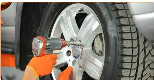
**49** Abaissez la voiture et serrez les boulons de roue en ordre croisé. Utilisez une clé dynamométrique. Serrez-le jusqu'à 150 Nm.
