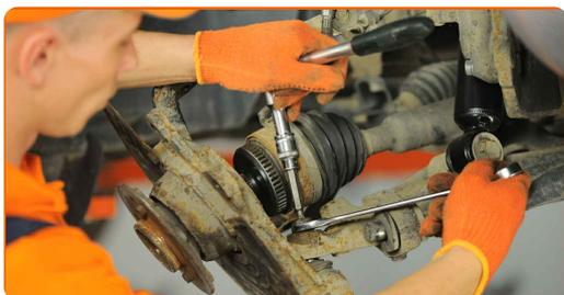
**34** Installez l'arbre d'entraînement dans le moyeu de roue.
