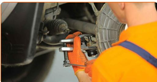
**16** Dévissez l'attache du capteur ABS de la fusée d'essieu. Utilisez une douille n° 10. Utilisez une douille n° E10. Utilisez une clé à cliquet.
