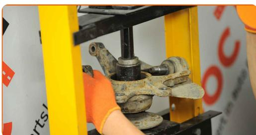
**31** Installez la fusée d'essieu et moyeu dans l'assemblage.
