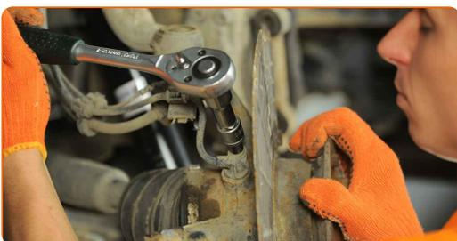
**17** Retirez le capteur ABS de la fusée d'essieu.
