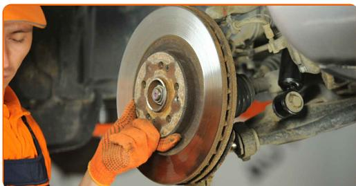
**42** Serrez l'attache du disque de frein. Utilisez la mèche Torx T30. Utilisez une clé dynamométrique. Serrez-le jusqu'à 9 Nm.
