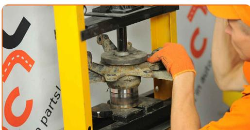
**29** Installez la bague de retenue. Utilisez les pinces à anneau de retenue.
