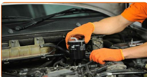
Remplacement : filtre à carburant – Mercedes ML W163. AUTODOC recommande :
