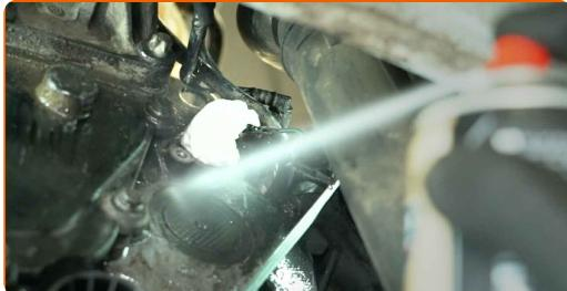
9 Traitez le connecteur du capteur de position de l'arbre à cames. Utilisez une bombe pour contacts électriques.
