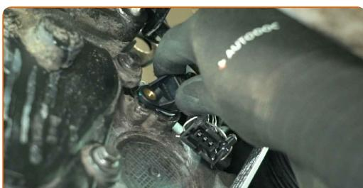
12 Installez et vissez le boulon de fixation. Utilisez une douille de 10 mm. Utilisez une clé à cliquet.
