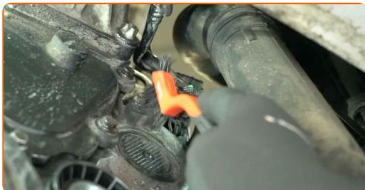
**3** Détachez le connecteur du capteur de position de l'arbre à cames.
