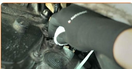
8 Nettoyez le siège de montage du capteur de position de l'arbre à cames. Utilisez un spray nettoyant multi-usages.
