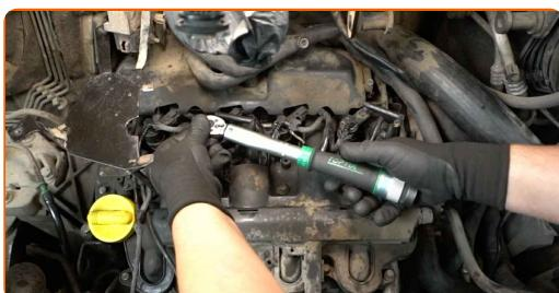
Remplacement : bougie de préchauffage – Renault Master 2 van. AUTODOC recommande :
