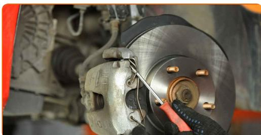
**8** Retirez les bouchons anti-poussière des goupilles de guidage de l'étrier de frein. Utilisez un tournevis plat.
