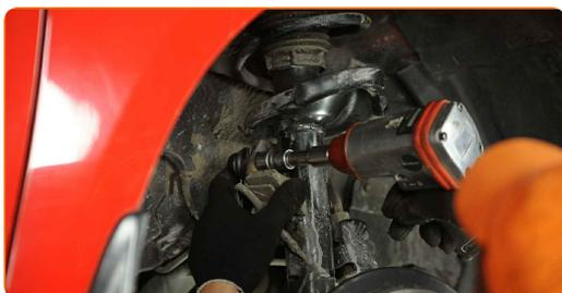
**50** Appliquez du produit sur les fixations de l'amortisseur. Appliquez du produit sur tous les joints du stabilisateur. Utilisez de la graisse au cuivre.
