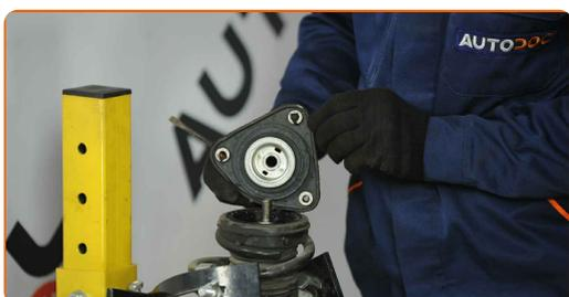
Remplacement : coupelle d'amortisseur – MAZDA 3 5 portes (BK). AUTODOC recommande :
