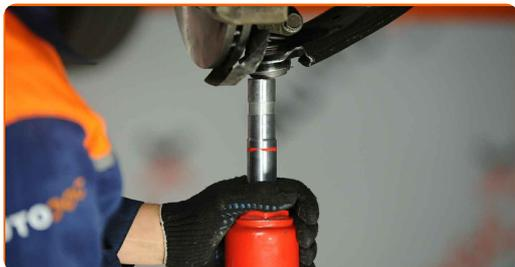
**42** Installez l'écrou de fixation.
