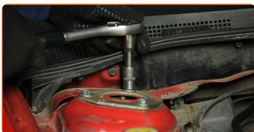
**36** Lubrifiez les fixations de la coupelle d'amortisseur. Utilisez de la graisse au cuivre.
