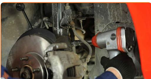
**14** Retirez l'écrou de fixation.
