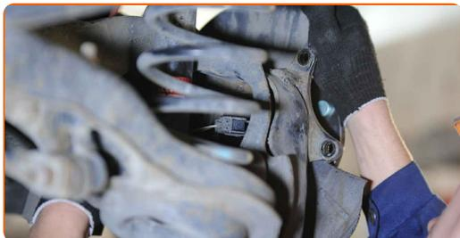
**37** Lubrifiez le moyeu à l'endroit où il est en contact avec le disque de frein. Utilisez de la graisse au cuivre.
