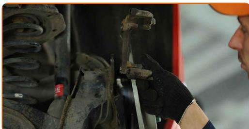
**43** Installez les boulons de fixation (2 pièces).
