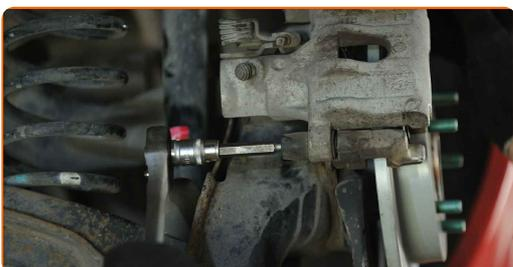
**47** Installez les bouchons anti-poussière des goupilles de guidage de l'étrier de frein.
