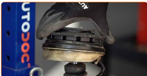
**33** Serrez l'écrou de l'entretoise d'amortisseur due la tige de piston. Utilisez la clé HEX n° H6. Utilisez une clé mixte de No.18. Utilisez une clé dynamométrique. Serrez-le jusqu'à 62 Nm.
