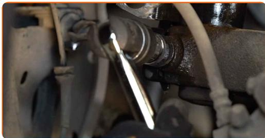
**16** Retirez l'écrou de fixation.
