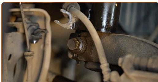
**15** Dévissez l'attache inférieure du support de l'amortisseur. Utilisez une douille n° 19. Utilisez un porte-taraud.
