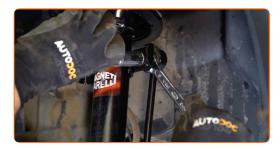
Serrez la fixation reliant la biellette à la barre stabilisatrice. Utilisez une douille n° 14. Utilisez une clé mixte de No.15 Utilisez une clé dynamométrique. Serrez-le jusqu'à 44 Nm.
