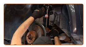
Serrez la fixation reliant la biellette à l'amortisseur. Utilisez une douille n° 14. Utilisez une clé mixte de No.15 Utilisez une clé dynamométrique. Serrez-le jusqu'à 44 Nm.
