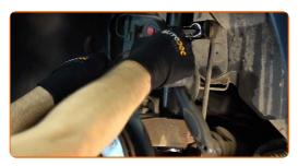
Dévissez la fixation reliant la biellette à la barre stabilisatrice. Utilisez la clé HEX n° H6. Utilisez une clé mixte de No.17 Utilisez une clé à cliquet.
