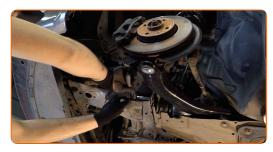
Serrez la fixation reliant le renfort de pare-chocs au support du radiateur inférieur. Utilisez une douille n° 18. Utilisez une clé dynamométrique. Serrez-le jusqu'à 75 Nm.
