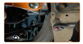
Relâchez la fixation reliant le joint à rotule au porte-fusée. Servez-vous d'une douille spéciale pour retirer l'amortisseur.
