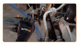
Dévissez l'attache du bras arrière. Utilisez une douille n° 18. Utilisez une clé mixte de No.18. Utilisez une clé à cliquet.
