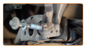
Vissez l'attache du bras avant. Utilisez une douille n° E16. Utilisez une clé mixte de No.18. Utilisez une clé à cliquet.
