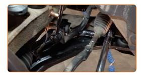
Serrez l'attache du joint rotule. Utilisez une douille n° 16. Utilisez une clé mixte de No.18. Utilisez une clé dynamométrique. Serrez-le jusqu'à 62 Nm.
