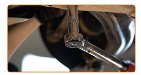
Serrez la fixation avant reliant le bras de commande au sous-châssis. Utilisez une clé mixte de No.16. Utilisez une clé mixte de No.18. Utilisez une clé dynamométrique. Serrez-le jusqu'à 105 Nm.
