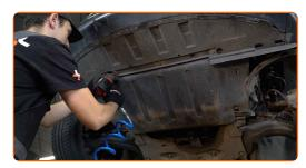
Dévissez et retirez les fixations des enjoliveurs. Utilisez la mèche Torx T20. Utilisez un outil d'extraction de clips.
