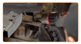
Dévissez les fixations du renfort de pare-chocs au sous-châssis. Utilisez une douille n° 13. Utilisez une clé à cliquet.
