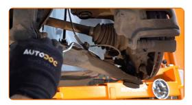
Dévissez l'attache entre le joint rotule et la fusée d'essieu. Utilisez une douille n° 16. Utilisez une clé mixte de No.18. Utilisez une clé à cliquet.
