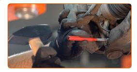
Dévissez l'attache du bras avant. Utilisez une douille n° E16. Utilisez une clé mixte de No.18. Utilisez une clé à cliquet.
