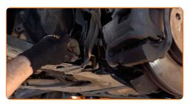
Retirez le support se trouvant sous celui du radiateur inférieur.
