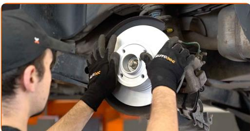
**19** Vissez l'écrou de blocage du moyeu de roue. Utilisez une douille n° 30. Utilisez une clé dynamométrique. Serrez-le jusqu'à 175 Nm.
