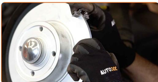
**24** Serrez le support de l'étrier de frein. Utilisez une douille n° E16. Utilisez une clé dynamométrique. Serrez-le jusqu'à 105 Nm.
