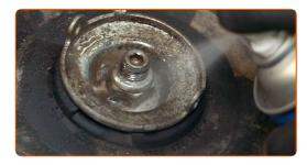
Retirez l'écrou de la tige de piston de l'entretoise. Utilisez une douille pour ecrou de jambe de suspension de 21 mm. Utilisez la clé HEX n° H6.
