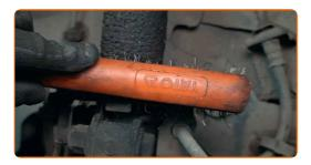
Dévissez l'attache qui relie le support du flexible de frein à la jambe de suspension. Utilisez une clé mixte de No.10
