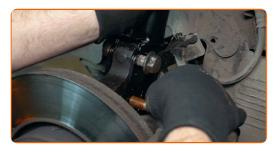
Vissez les fixations reliant la jambe de suspension à la fusée d'essieu. Utilisez une clé mixte de No.21. Utilisez une douille n° 21. Utilisez une clé à cliquet.
