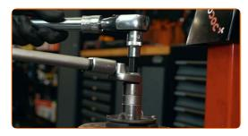
Lubrifiez la barre d'amortisseur. Utilisez de la graisse au cuivre.
