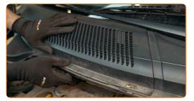
Installez la grille d'auvent et fixez-la. Utilisez la mèche Torx T20. Utilisez une clé à cliquet.
