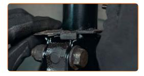
Serrez l'attache qui relie le support du flexible de frein à la jambe de suspension. Utilisez une clé mixte de No.10
