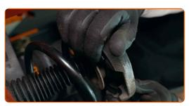
Serrez l'écrou de l'entretoise d'amortisseur due la tige de piston. Utilisez une douille pour ecrou de jambe de suspension de 21 mm. Utilisez la clé HEX n° H6. Utilisez une clé dynamométrique. Serrez-le jusqu'à 60 Nm.
