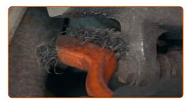
Dévissez l'attache de l'étrier de frein. Utilisez une clé mixte de No.15 Utilisez une douille n° 13. Utilisez une clé à cliquet.
