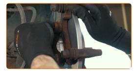
Serrez le support de l'étrier de frein. Utilisez une douille n° 18. Utilisez une clé dynamométrique. Serrez-le jusqu'à 24 75 Nm.
