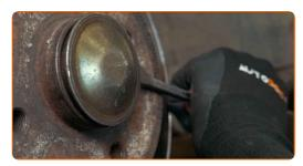
Dévissez l'écrou de moyeu. Utilisez une douille n° 30. Utilisez un porte-taraud.
