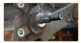
Installez le disque de frein assemblé avec le palier de moyeu de roue.
